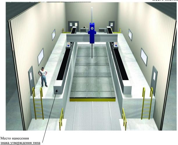
Рисунок 1 - Внешний вид машин трёхкоординатных измерительных портальных LK V-GP и место нанесения знака утверждения типа
