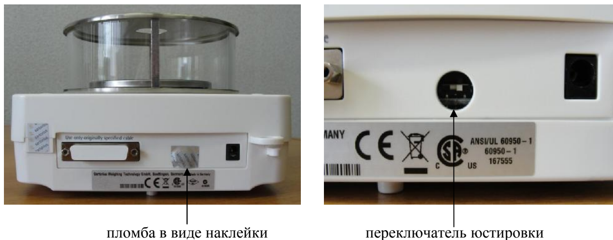
Рисунок 2 - Схема пломбировки от несанкционированного доступа.
