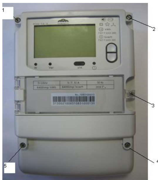
Рисунок 1 – Общий вид счетчика М300 и места пломбировки: 1 – пломба предприятия-изготовителя; 2- пломба поверителя; 3 - пломба крышки дополнительного щитка, закрывающего кнопку программирования; 4 и 5 – пломбы энергоснабжающей организации.
