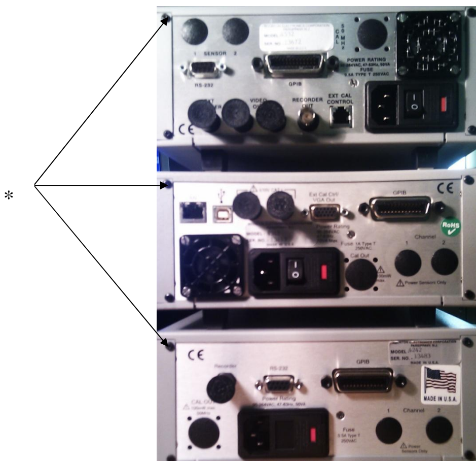
Рисунок 5 - Места пломбировки на задней панели блоков измерительных 4532 (4531) – верхний блок, 4241 (4242) - нижний блок, 4541 (4542)
