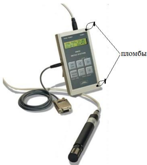
Рисунок 2. Схема пломбирования метеостанции НМ-30.
