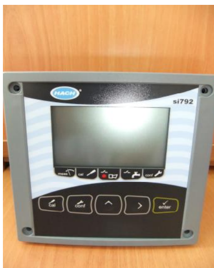
Рис. 1. Преобразователь измерительный потенциметрический модели si792x P
