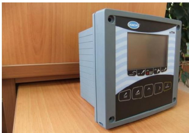
Рис.2. Преобразователь измерительный потенциометрический модели si794 P
