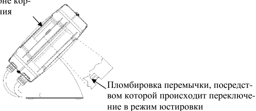
Рисунок 5 — Схема пломбировки индикатора
