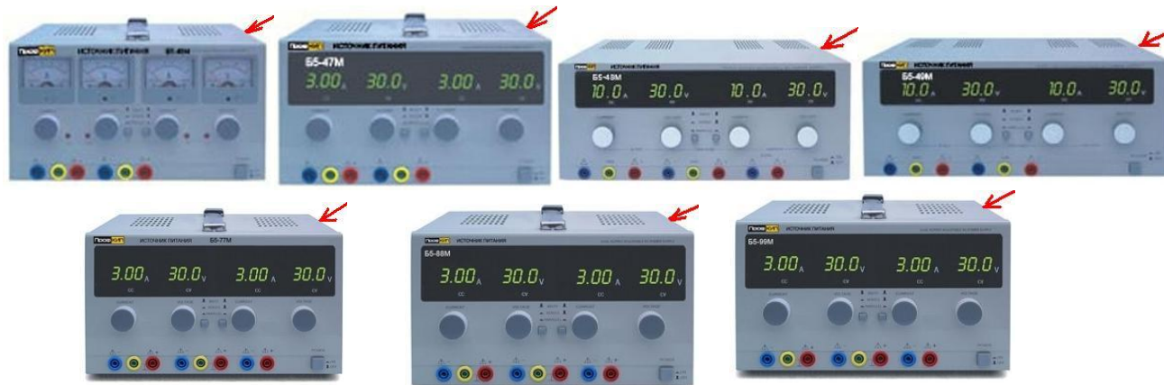
Рисунок 2 – Схема пломбировки от несанкционированного доступа.
