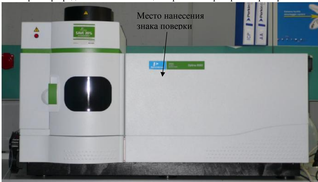
Рисунок 1 – Общий вид спектрометра эмиссионного с индуктивно-связанной плазмой Optima 8000
