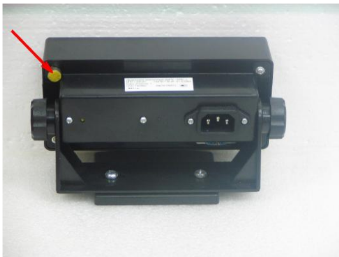
Рисунок 3. Схема пломбировки от несанкционированного доступа и обозначение места для нанесения оттиска клейма.
