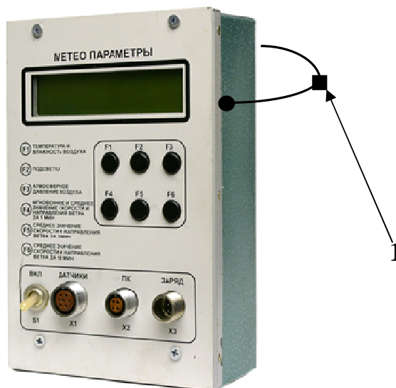
Рис. 2 Схема пломбирования блока цифрового в ДМК-01. 1 – пломбы.
