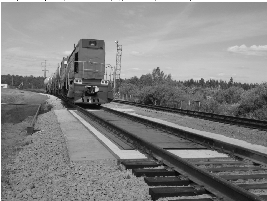
Рисунок 1 –Общий вид весов вагонных ВВЭ – С
