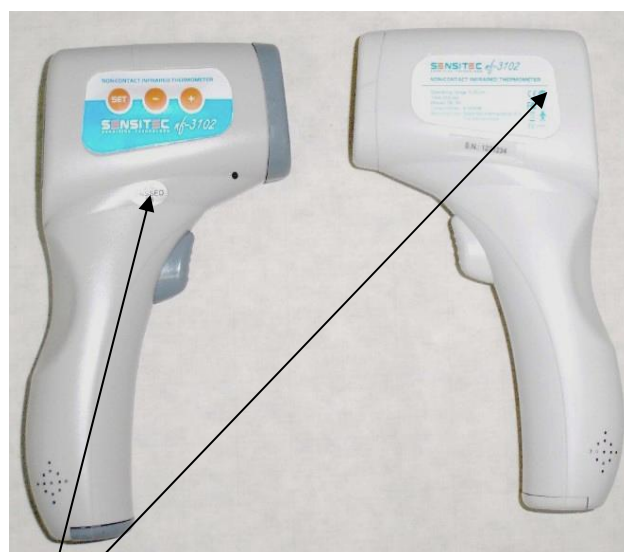
Место нанесения знака утверждения типа Место пломбировки от несанкционированного доступа Рисунок 2 – Модель SENSITEC NF-3102
