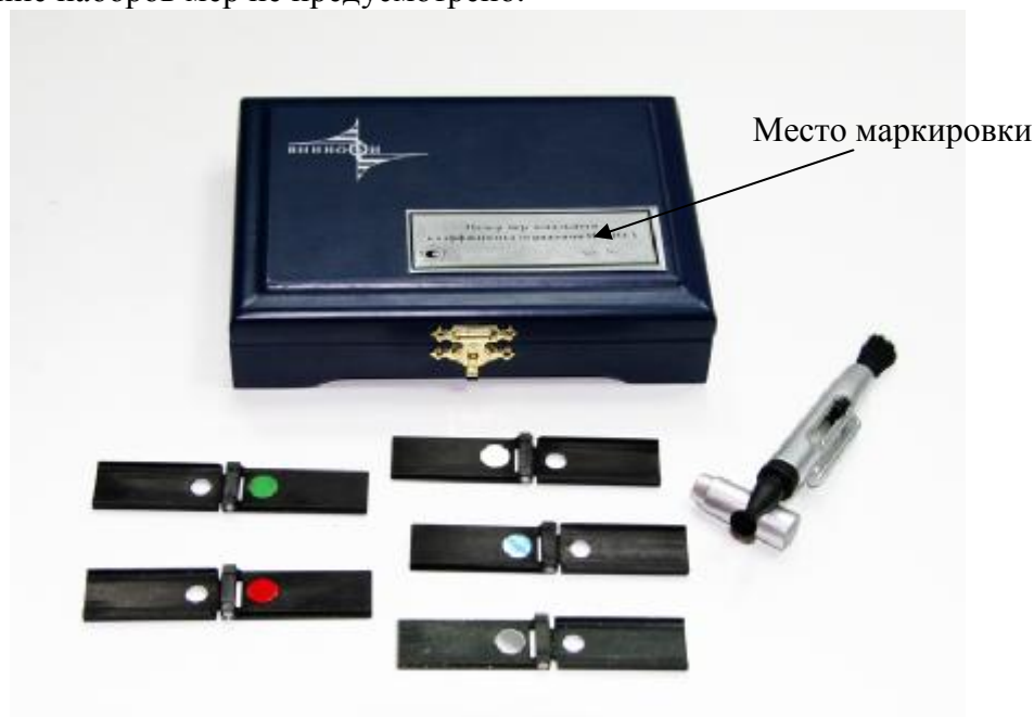
Рисунок 1 –Общий вид набора мер зональных коэффициентов отражения НМЗО-1 с указанием места маркировки
