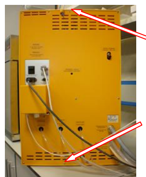
Рисунок 2 - Места пломбирования анализаторов Varodest 50s
