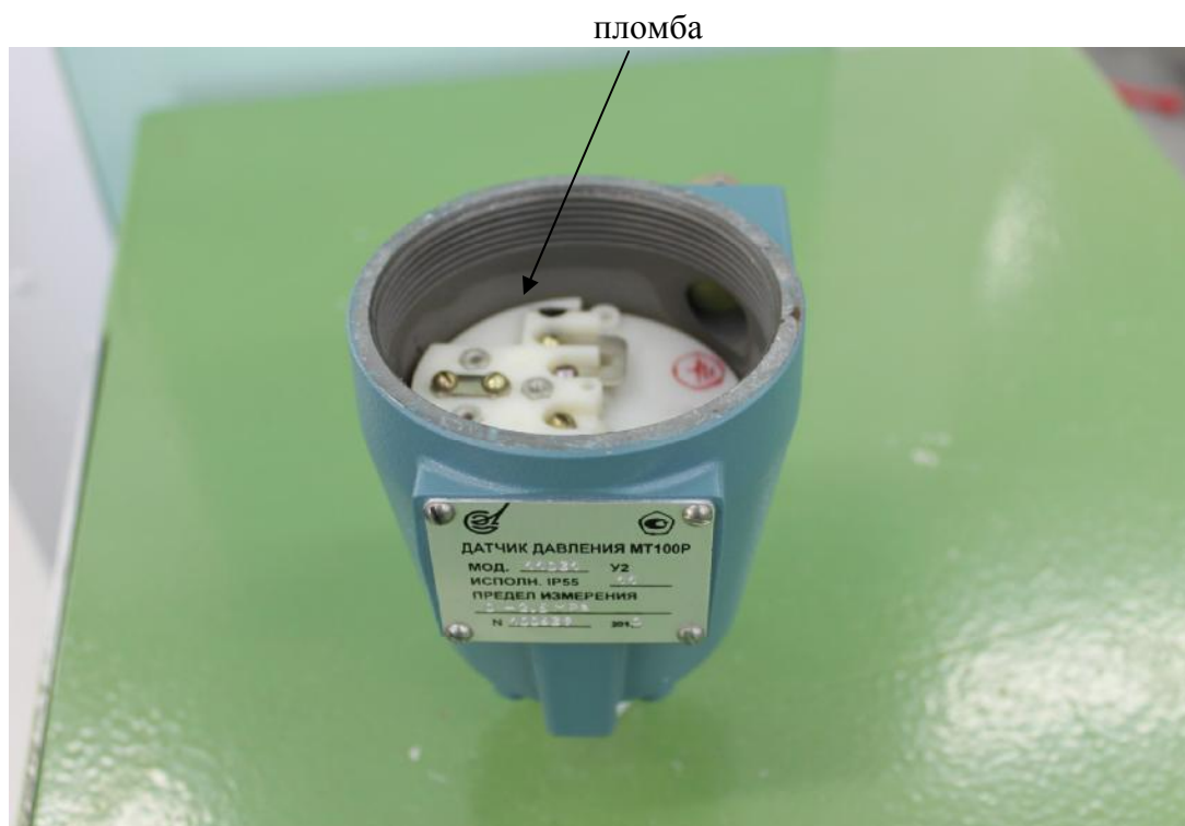
Рисунок 2 - Пломбирование датчиков давления МТ 100
