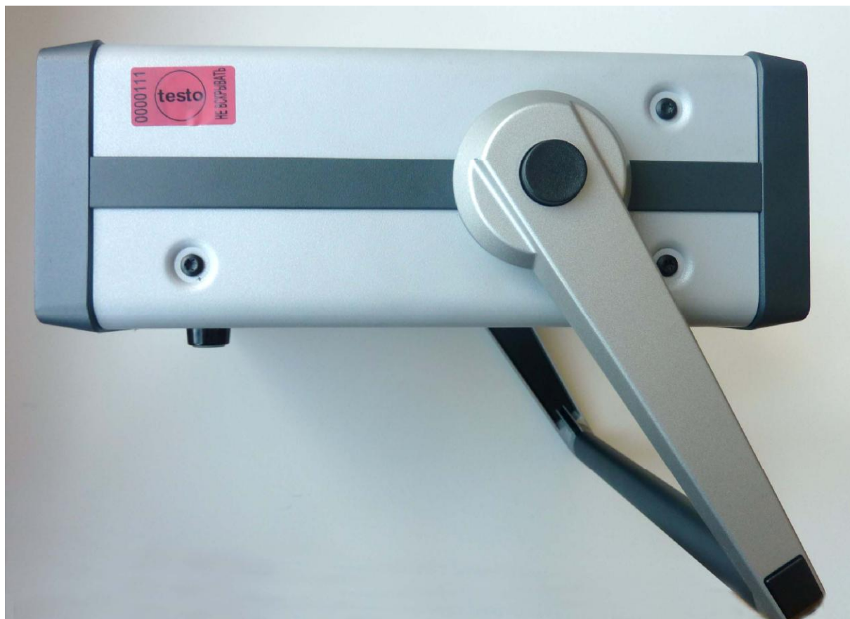
Рисунок 2 - Защита от вскрытия в виде наклейки на калибраторах давления Pneumator
