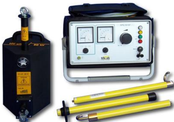
Установка КРГ 50кV
