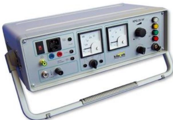
Установка КРГ 25 кV
