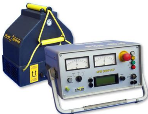
Установка КРГ 20 кV VLF
