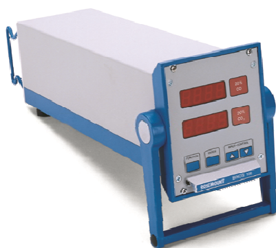
Фотография общего вида газоанализатора BINOS 100
