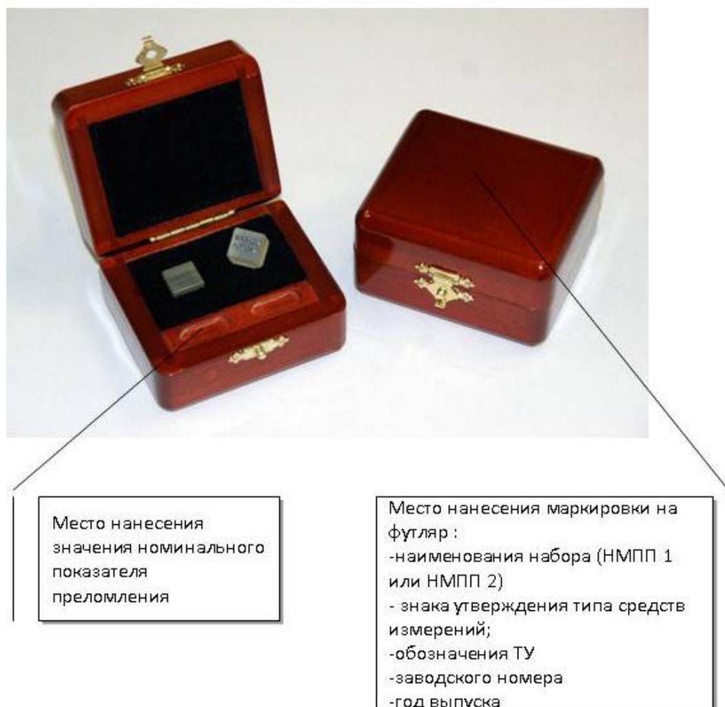
Рисунок 2 – Общий вид набора мер показателя преломления (НМПП 1 или НМПП 2).
