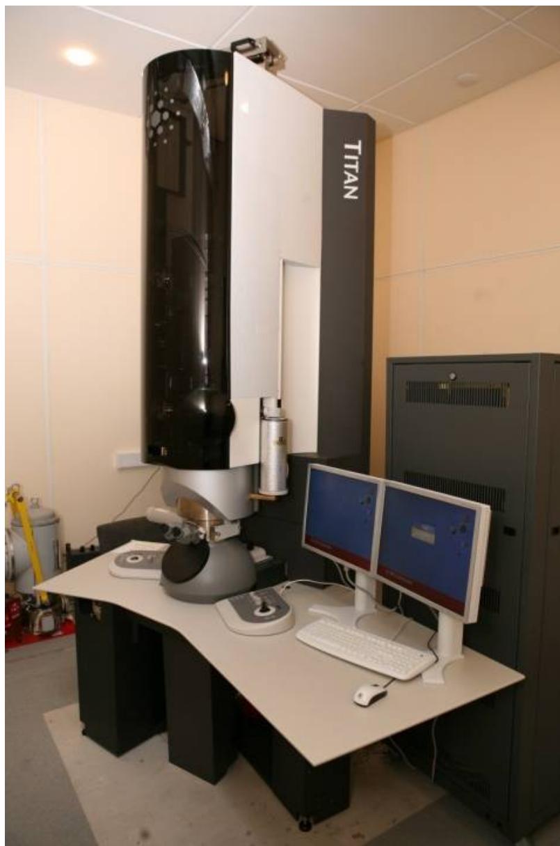
Рис. 1. Общий вид микроскопа электронного просвечивающего ТИТАН 80-300
