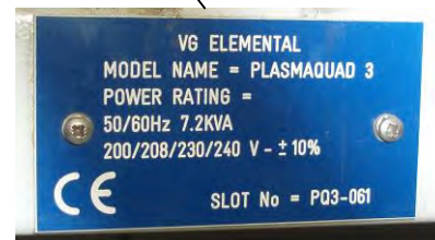
Рисунок 2 – Масс-спектрометр с индуктивно-связанной плазмой «Plasma Quad 3». Вид сзади. Места нанесения маркировки и пломбирования
