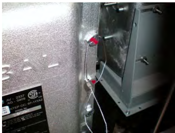
Рисунок 2 - Схема пломбирования блока-регистратора колонок DAM / НАМ
