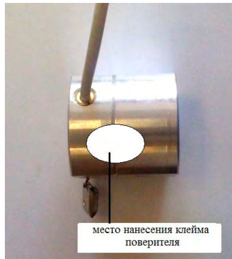
Фото 2 - Схема пломбировки преобразователя от несанкционированного доступа и обозначение мест для нанесения наклеек с клеймом поверителя
