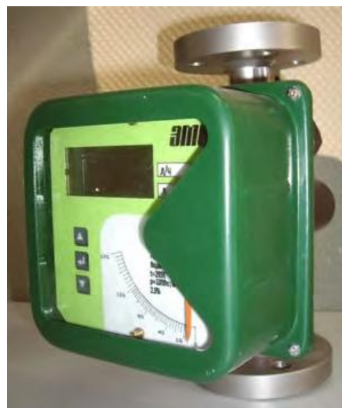
Рисунок 1.5 – Общий вид ротаметра ЭМИС-МЕТА 215, DN 15 с дополнительным считыванием показаний по ЖК дисплею
