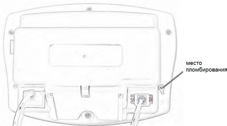
Рисунок 3. Схема пломбирования весов Seller SL-300
