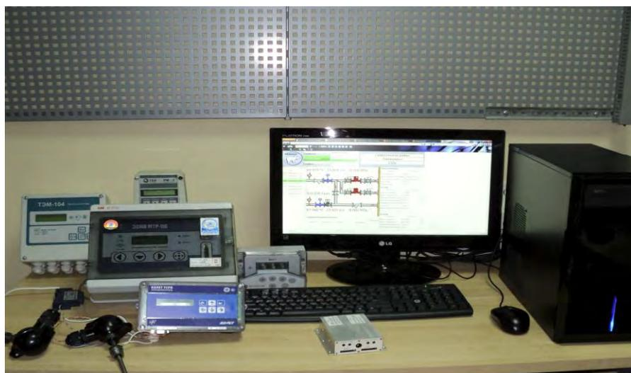
Нижний уровень ИИС состоит из измерительных компонентов, образующих измерительные каналы (далее –ИК). Измерительные компоненты являются средствами измерений, внесенными в Федеральный информационный фонд по обеспечению единства измерений.
