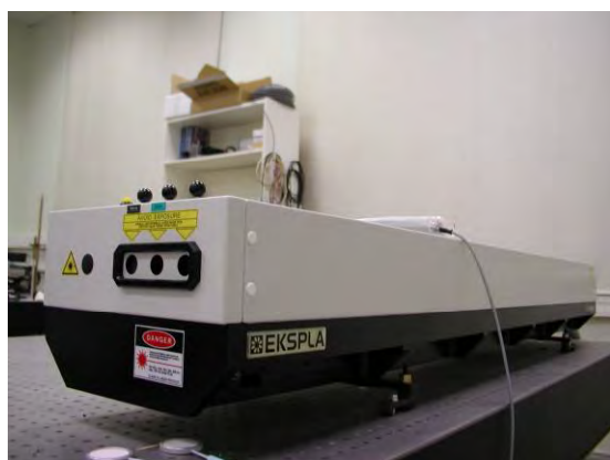
Рисунок 1 – Общий вид пикосекундного Nd:YAG лазер EKSPILA PL2143A (а) и фемтосекундного лазерного комплекса на кристалле хром-форстерита (б).
