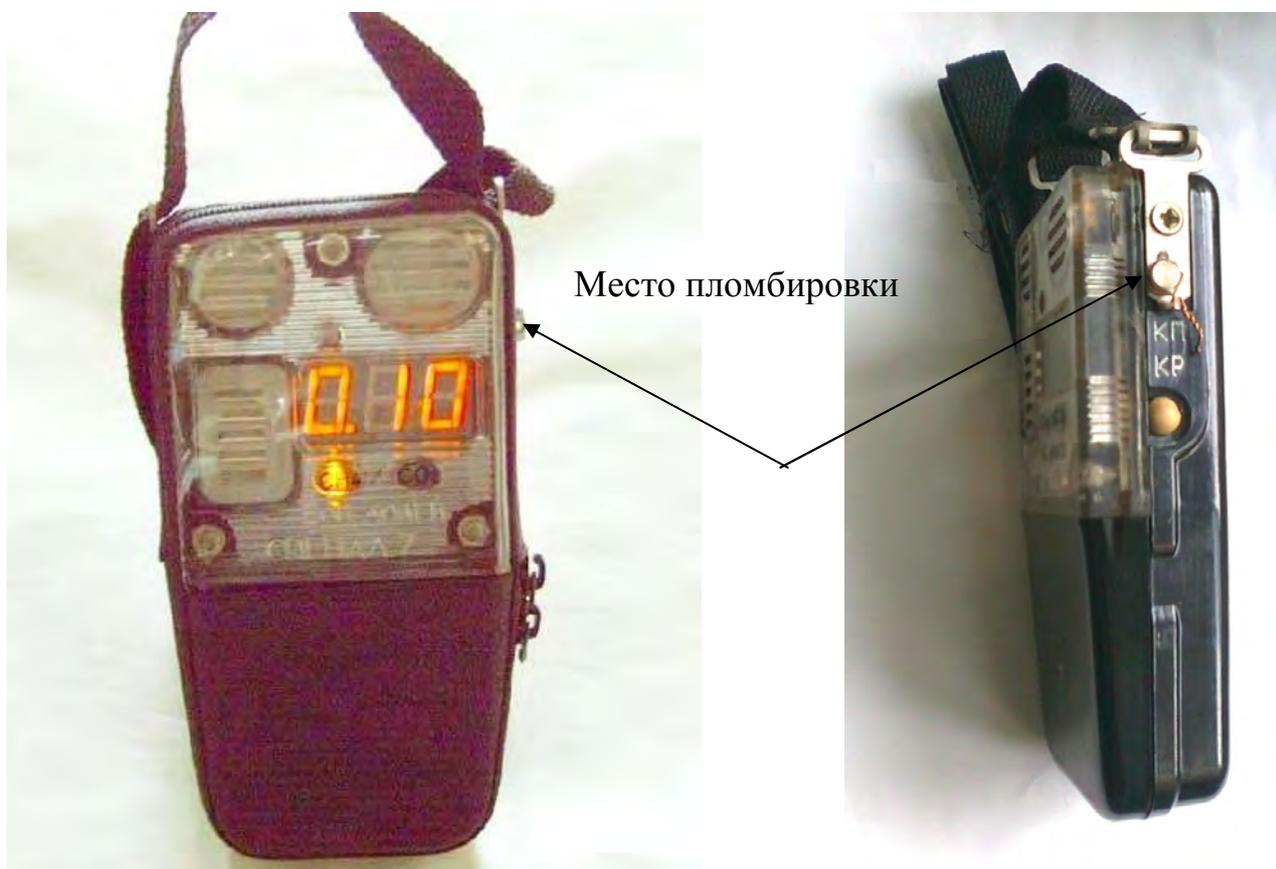
Общий вид прибора с указанием места пломбировки
