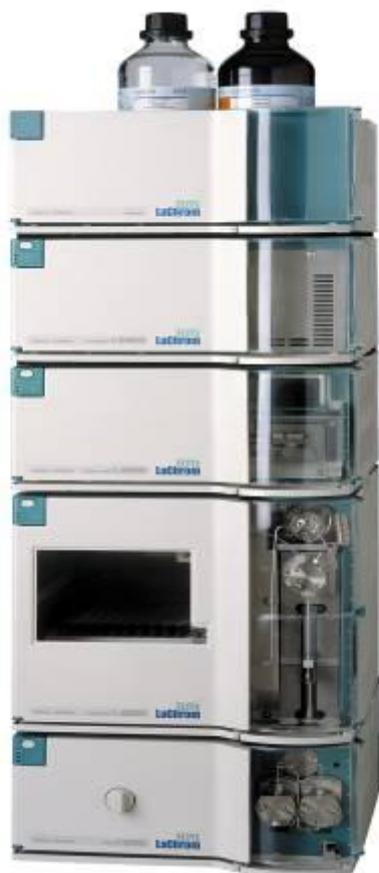
Рис. 1. Фотография общего вида хроматографа жидкостного "LaChrom Elite".
