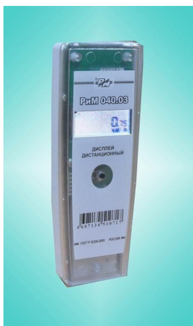
Рисунок 3 – Фотография общего вида и место установки пломбы изготовителя дисплея дистанционного РИМ 040.03 (одно из исполнений)
