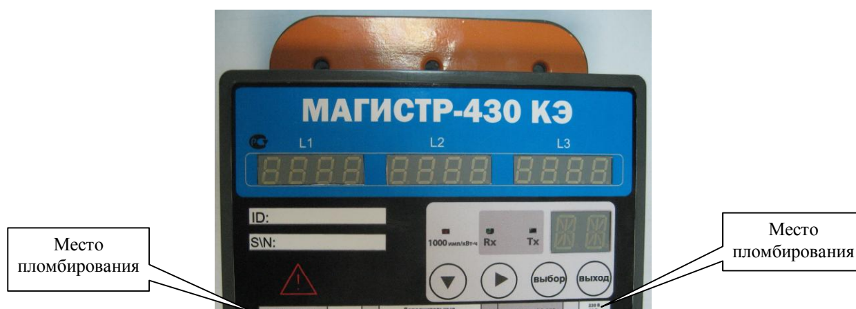
Рисунок 1 – Общий вид и место пломбирования измерителей электрических параметров качества, мощности и количества электрической энергии телеметрического МАГИСТР-430 КЭ
