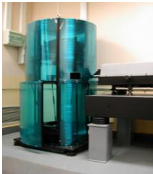
Рис. 1 – Внешний вид интерферометра фотоэлектрического «Физо»
