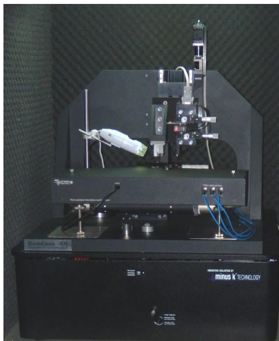
Рисунок 1 – Общий вид Микроскопа сканирующего зондового НаноСкан-3Di
