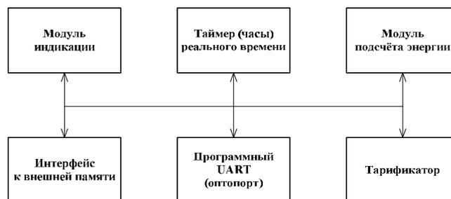
Рисунок 5 - Структура программного обеспечения «Меркурий 234»
