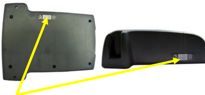
Рисунок 3 - Места защитных пломб
