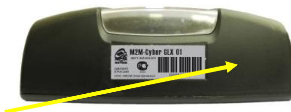
Рисунок 2 - Место нанесения знака об утверждении типа
