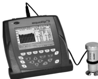
Рисунок 1 - Внешний вид твердомеров портативных Equostat
