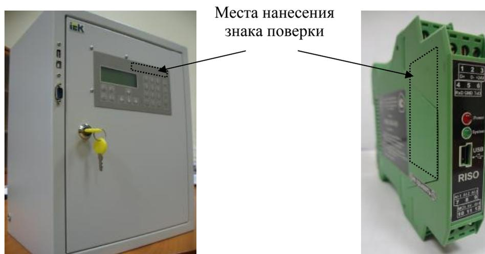
Рисунок 1 - Общий вид ИВК и места нанесения знака поверки
