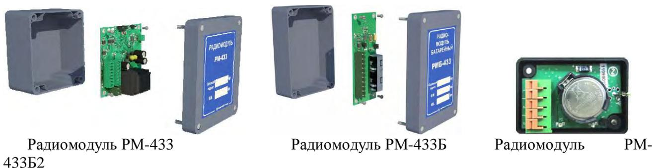
Рисунок 2б. Фотографии общего вида аппаратных средств ПТК «Спутр-М» - радиомодулей RM-433.
