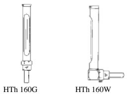
Термометры серии VMTh выполнены в виде толстостенного стеклянного капилляра призматической формы, в нижней части которого находится резервуар, наполненный термометрической жидкостью. Капилляр закреплен в корпусе, сделанном из алюминия или алюминиевого сплава с защитным анодированием под цвет латуни. Нижняя (монтажная) часть корпуса сделана из латуни или из нержавеющей стали. Шкала нанесена на капилляре, цифровые отметки - на корпусе.
