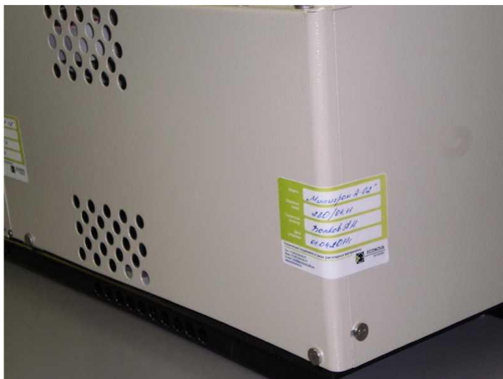
Рисунок 4 - Место 3 пломбирования для защиты от несанкционированного доступа
