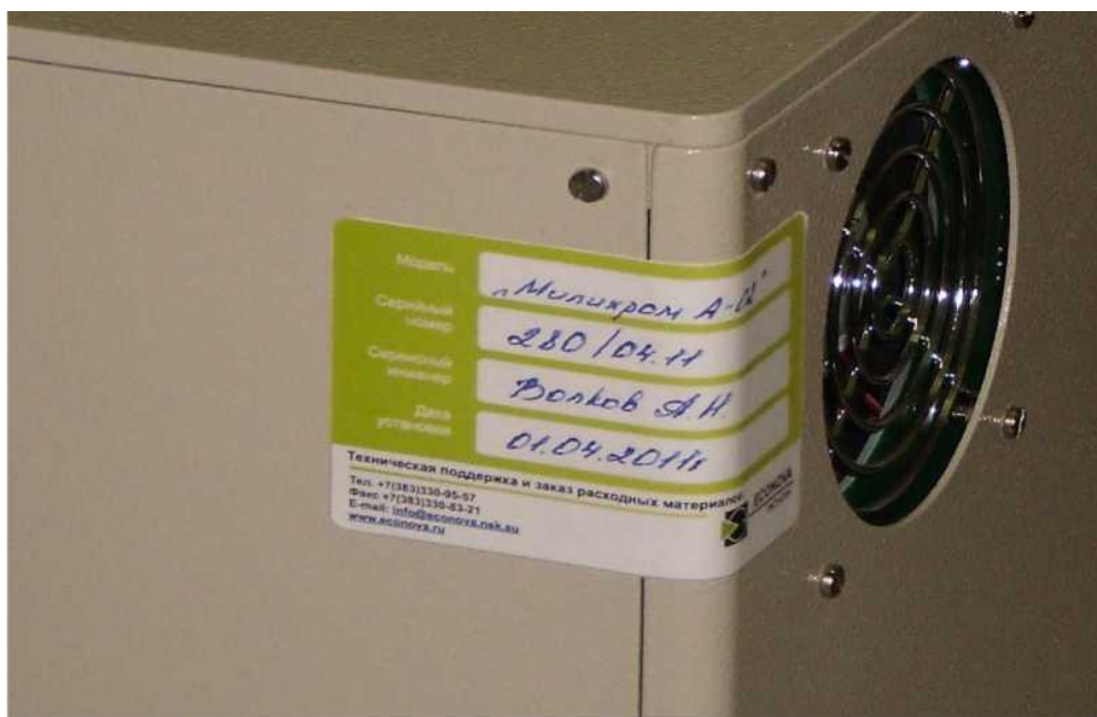
Рисунок 3 - Место 2 пломбирования для защиты от несанкционированного доступа
