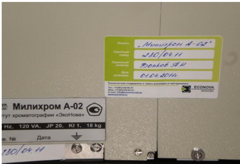
Рисунок 2 - Место 1 пломбирования для защиты от несанкционированного доступа
