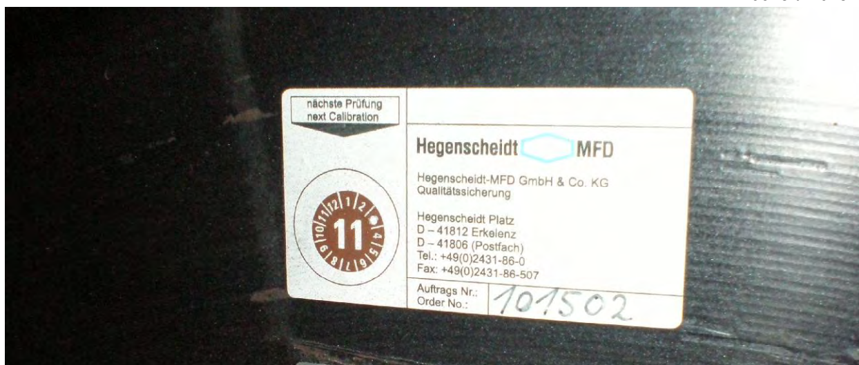
Рисунок 3 - Место нанесения знака утверждения типа на торце каждой колесной пары
