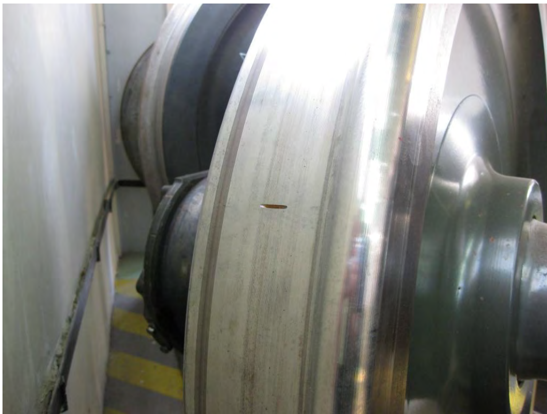
Рисунок 1 - Колесная пара с искусственным дефектом
