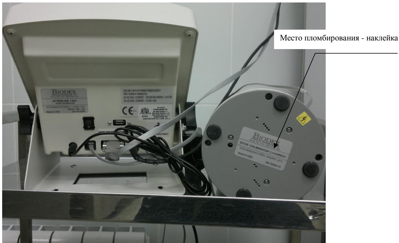
Рисунок 1б — Место пломбирования от несанкционированного доступа
