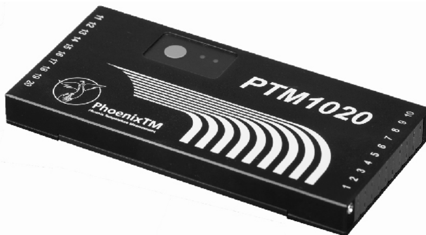
Фото 1 - Общий вид регистратора температуры электронного модели РТМ
