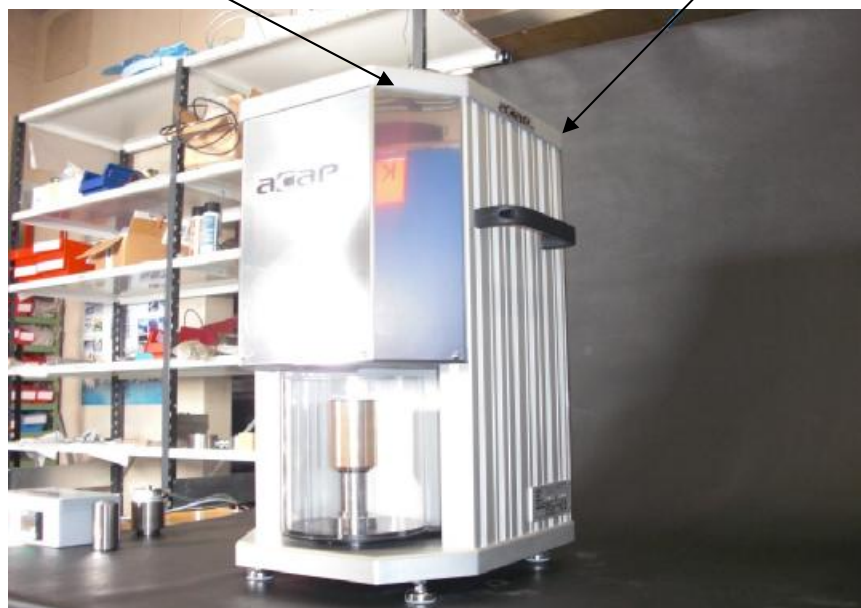
Рисунок 1 - Общий вид анализатора слеживаемости ACAP Easy
