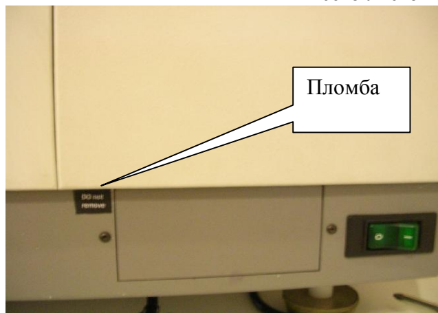
Рисунок 4 - Анализатор - коагулометр Destiny Max. Расположение пломбы.
