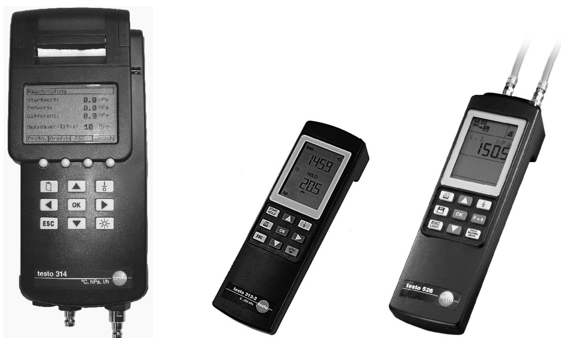
Фото 2-Измерители дифференциального давления TESTO 314, TESTO 312, TESTO 526
