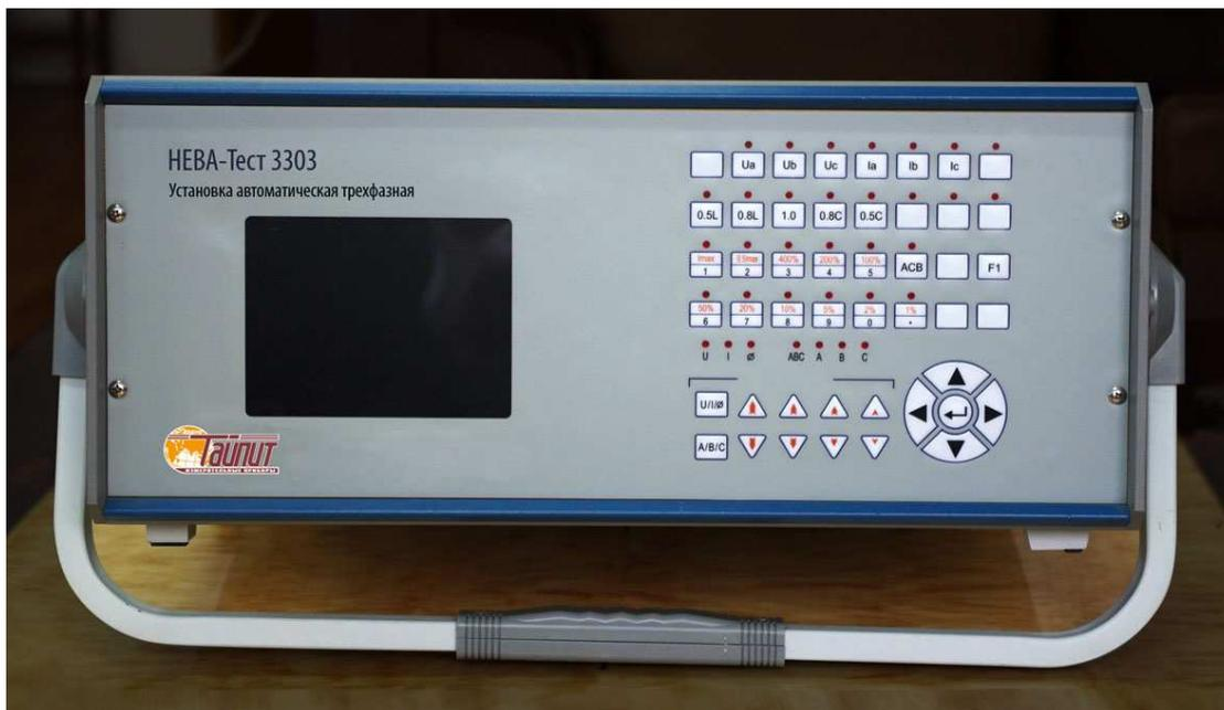
Рис. 2 Установка HEVA-Тест 3303П
