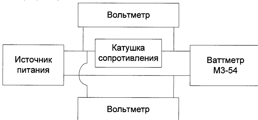
Рис.2. Схема определения изменения коэффициента преобразования ваттметра М3-54 в диапазоне мощностей.
