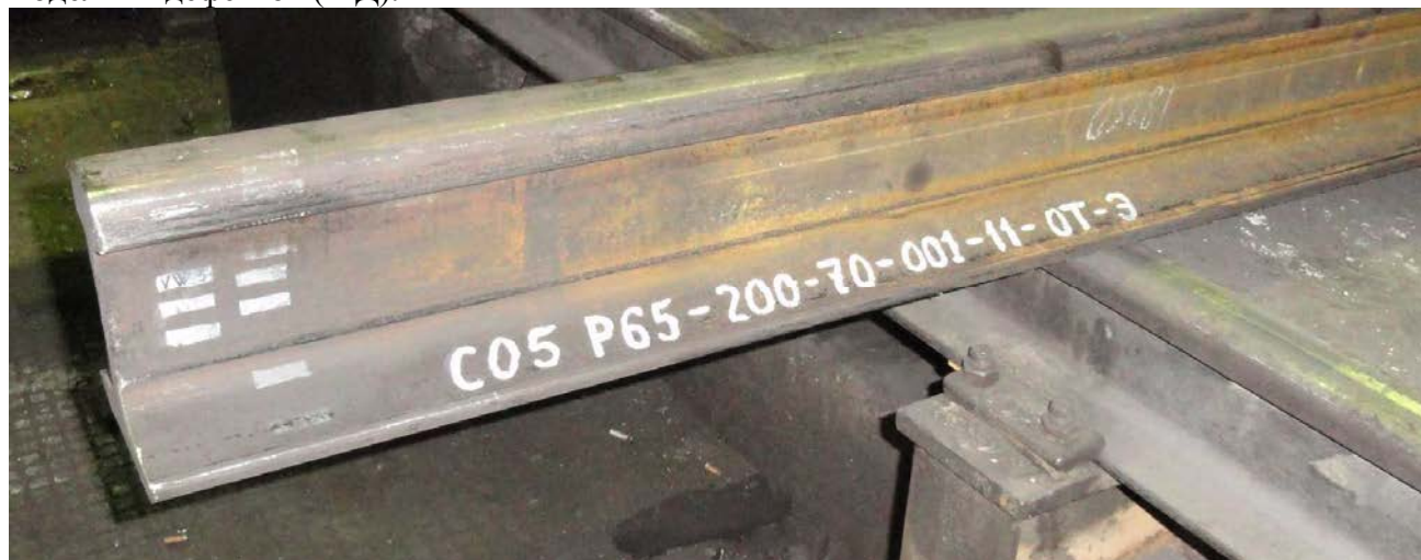
Рисунок 1 - Общий вид комплекта мер моделей дефектов СО5
